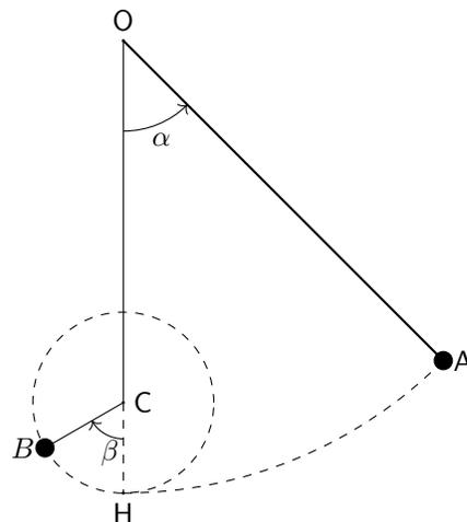
FIGURE 1 – À gauche : dessin d'artiste représentant la manipulation du sheng biao (crédit Erika Shing). À droite : schéma du pendule à butée. La butée est en C, les points A et B sont les positions extrêmes du pendule.
