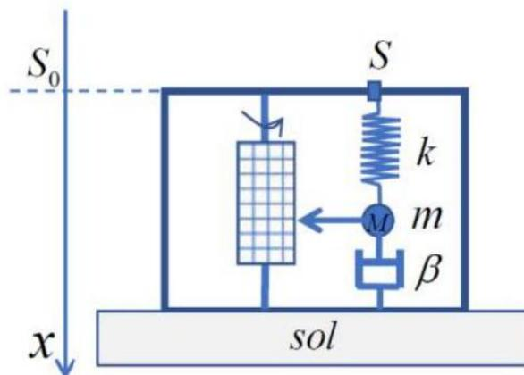
À l'instant initial l'altitude du point  $S$  coïncide avec celle d'un point  $S_0$  fixe dans un référentiel  $\mathcal{R}_0$  galiléen. On pourra utiliser le repère  $(S_0, x, y, z)$  associé à  $\mathcal{R}_0$ .
