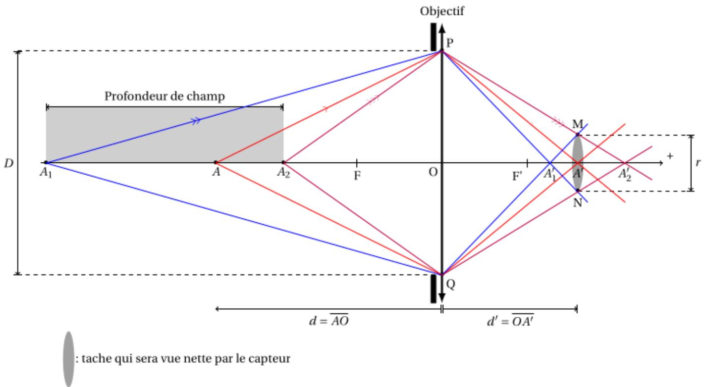
FIGURE 4 – Représentation de la profondeur de champ en fonction d'une distance de mise au point  $d$ , de la taille d'un pixel  $r$ , du diamètre du diaphragme  $D$ . Pour voir net un objet situé entre les plans passant par  $A_1$  et  $A_2$  et perpendiculaires à l'axe optique il suffit que le diamètre de la tâche dans le plan passant par  $A'$  et perpendiculaire à l'axe optique soit de la même taille qu'un pixel du capteur CCD.
